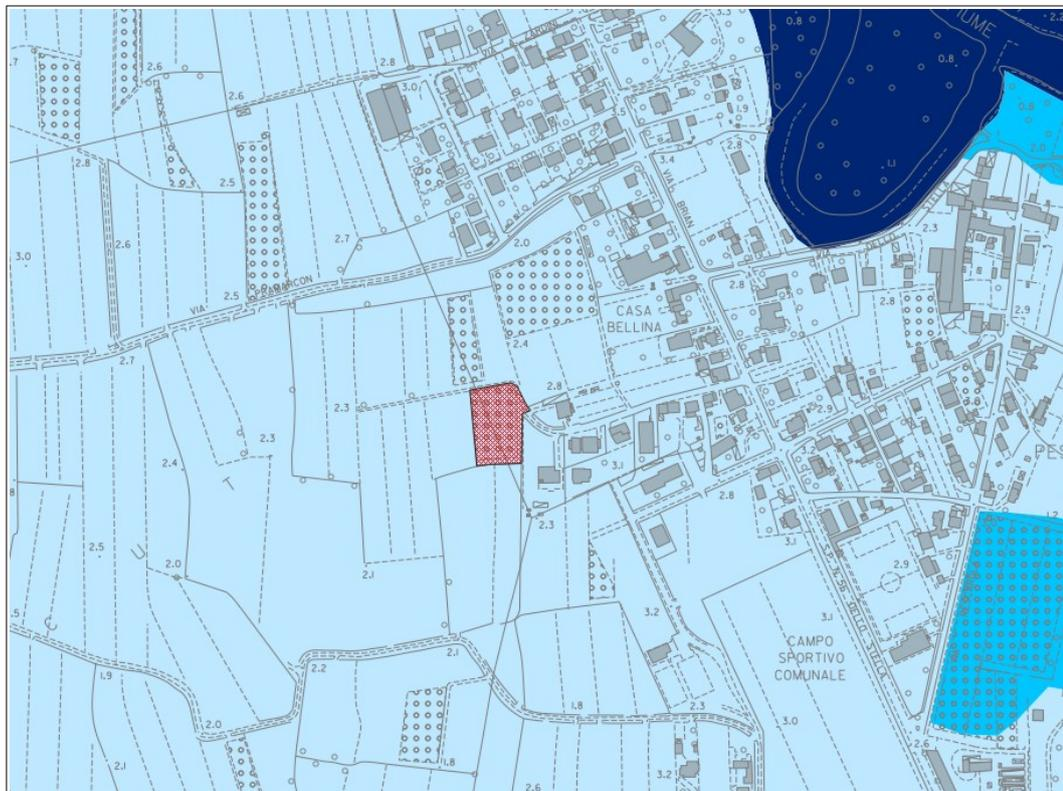
Figura 3 - Estratto (non in scala) del PAIR. In celeste la classe di pericolosità idraulica P1 bassa, in blu scuro l'area fluviale, F
